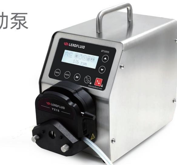
BT300S调速型智能蠕动泵采用进口内核处理器，高品质步进电机驱动，转速控制精度高达 $\pm 0.2\%$ ；通过雷弗APP软件，可对泵进行远程控制，并对运行状态实时监测；RS485通讯，兼容Modbus协议，可通过多种信号模式与计算机、单片机、PLC、变频器、人机界面等上位机连接，实现系统化集中控制。
