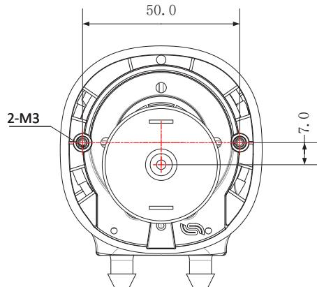
图2 Z245A2-KX1502泵头安装图
