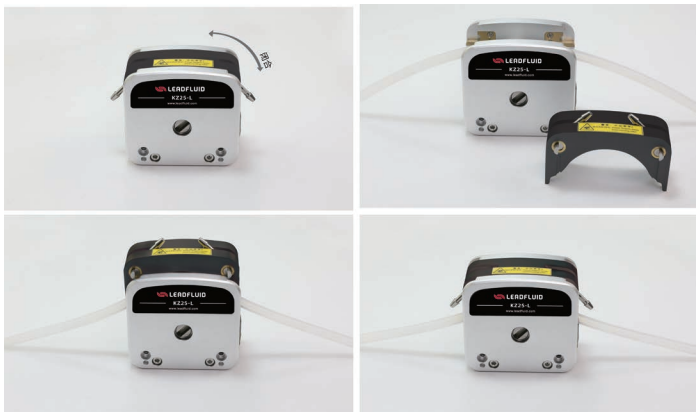
软管安装方式（AL）
