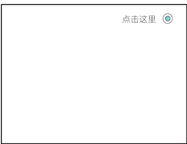
图53 触摸屏右上方测试点校正界面
