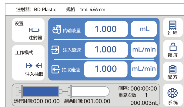
图16 注入抽取过程显示界面
