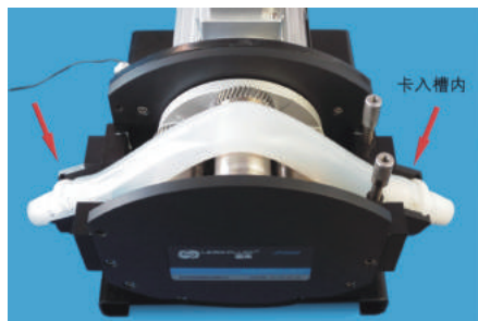
图5 泵管安装图(第二步)
