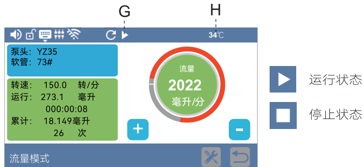
图10 泵顺时针运转运行时
