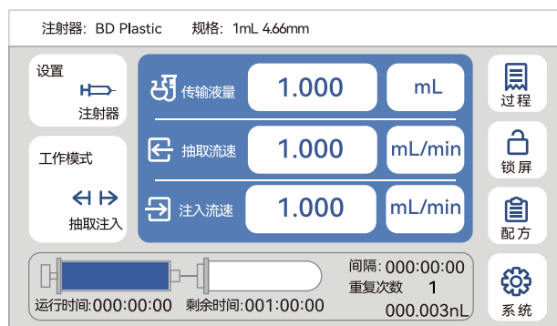
图17 抽取注入过程显示界面
