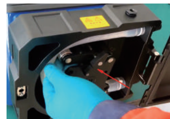
图11 泵管另一端安装到卡槽内，搬杆搬到左侧
