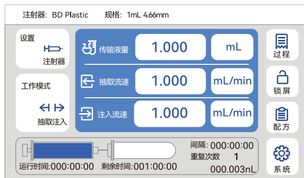
图16抽取注入过程显示界面
