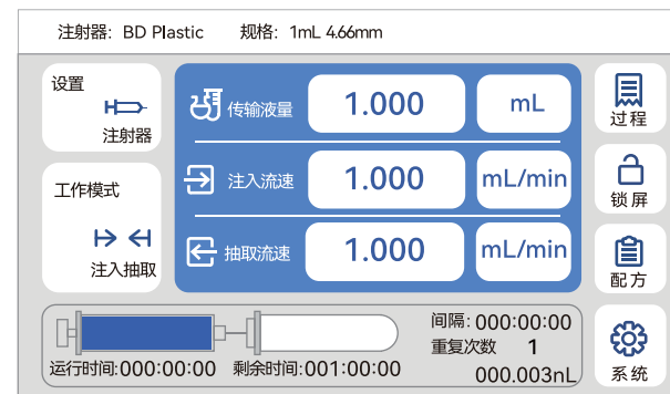
图15注入抽取过程显示界面
