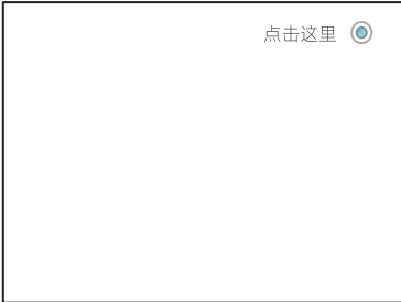
图58 触摸屏右上方测试点校正界面
