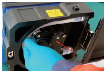
图11 泵管另一端安装到卡槽内，搬杆搬到左侧
