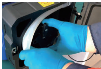
图10 顺着圆弧方向安装泵管，同时旋转滚轮芯
