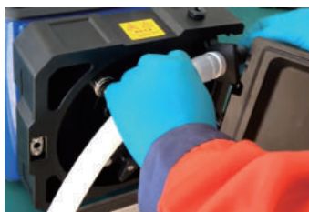
图9 将泵管一端放入卡槽内
