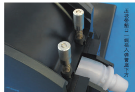
图11 泵管安装图(第三步)
