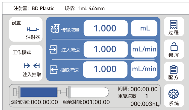
图15 注入抽取过程显示界面
