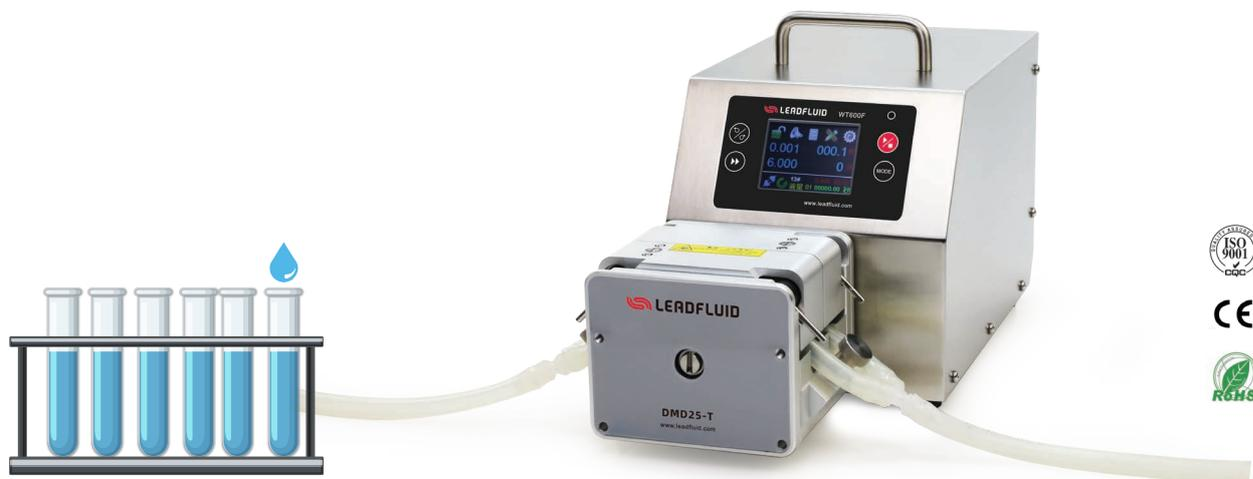
雷弗 WT300F蠕动泵主要适用于0.1~200ml液体的高精度分装，灌装精度误差范围 $\pm 0.5\sim 1\%$ ；采用直流无刷伺服电机驱动，彩色高清液晶显示，触摸屏操作，可直接输入灌装液量、运行流速、工作次数等参数，既可手动操作，也可以配套自动灌装生产线使用。
