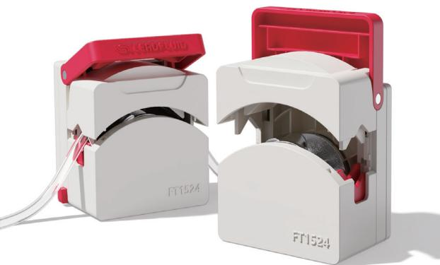
FT1524蠕动泵泵头采用坚固的IXEF材质，适用硅胶和pharmed材质软管，适配多种管径，连续流量可达1900mL/min，为多样化的应用提供便捷解决方案。泵头特有的翻盖设计提高了使用便利性，方便用户更换软管并保证系统卫生性。安装尺寸适应性广，兼容多种常见装配规格。
